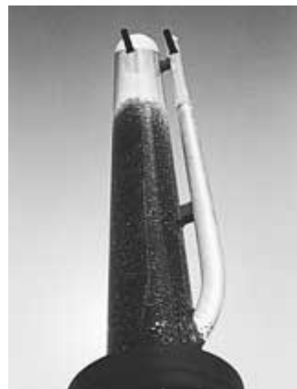
EIMO-Reaktor, Bioreaktor und Absetzzone: Das verschmutzte Wasser gelangt von oben in den feinblasig belüfteten Bioreaktor (Zylinder links), dort entfernen die EIMO die biologisch abbaubaren, gelösten Stoffe. Nach der Reinigung verlässt das Wasser den Bioreaktor unten über den Seitenstutzen und durchströmt die Absetzzone (Zylinder rechts) von unten nach oben, dabei findet die Abtrennung des gereinigten Wassers von den EIMO-Kapseln statt.
