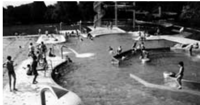
Dieses Bild zeigt in eindrucksvoller Art die Stärke des Werkstoffes Edelstahl-Rostfrei. Ein Betonbecken 50 x 25 m sollte attraktiv gestaltet werden. Dazu wurde die grosse Wasserfläche in einzelne Bereiche aufgelöst: Sportbereich mit 4 Bahnen à 50 m, Strömungskanal, abgeschirmter Wasserrutschen-Zielbereich, Nichtschwimmerzonen, Inseln zur Beckenteilung – und dies alles in einem alten Betonbecken ohne Probleme der Dichtheit bei den neuen Seitenwänden.
