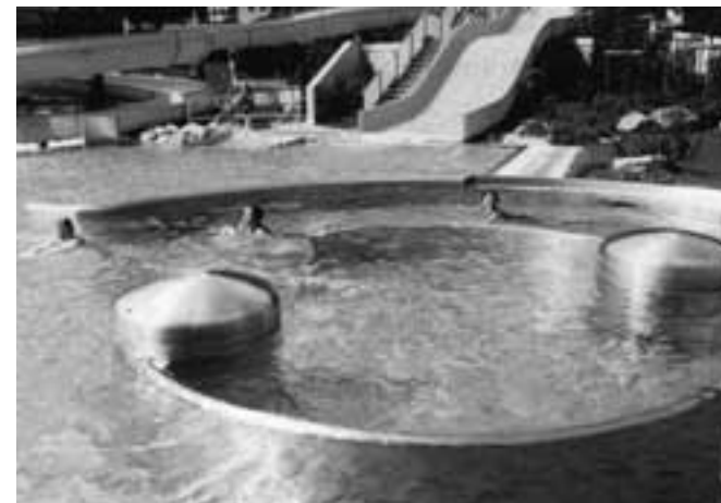
Ganz anders als im Bild nebenan wird hier die Zone des Strömungskanals aufgelockert. Zwei kleine, kuppelartige Sitz- bzw. Kletterinseln sowie zwei Öffnungen zur zentralen Wasserfläche beleben. Im Hintergrund erkennt man die Breitrutsche und eine Grossrutsche mit Sicherheitslandezone.
