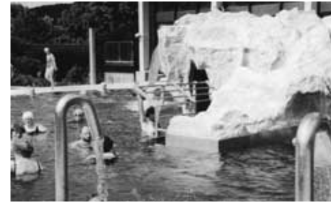
Eine Insel im Becken, ausgeführt als durchschwimmbare Grotte aus Kunstfelsen mit einer Gymnastikeinrichtung und im Vordergrund Wasserkanonen sind Teile dieses Wassergymnastik-Beckens.
