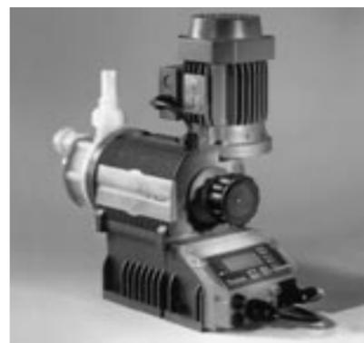
Die Sigma/1-Dosierpumpe komplettiert diese Baureihe für den unteren und mittleren Leistungsbereich von 1 l/h bis 1000 l/h. Ihre Mikroprozessor-Steuerung mit optimaler Kombination aus Drehzahlregelung und Stop & Go-Betrieb gewährleistet exaktes Dosieren, auch im unteren Minimalbereich.
