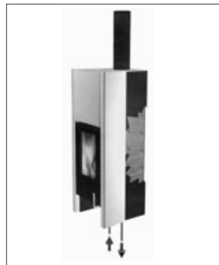
Graphische Darstellung des Speicherofens «T-Loft plus» mit aufgeschnittener Seitenwand und sichtbarem Absorber (rechts).
