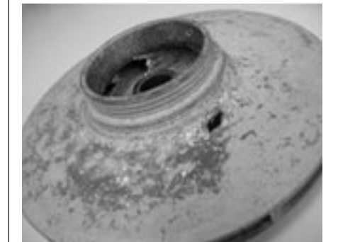
Anhand dieses Bildes sieht man, dass auch eine Pumpe konsequent kontrolliert werden muss. Nur so fällt auch auf, dass der Druck der Pumpe langsam abnimmt und ein Austauschen des Laufrades sich aufdrängt. Im Bogn Engiadina Scuol werden die Schaufelräder und die Lager der Solewasserumwälzpumpen nun spätestens nach fünf Jahren gewechselt.
