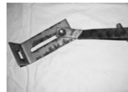
Achten Sie bei Änderungen auf die richtige Materialwahl. Im Badebereich muss ein spezieller Stahl eingesetzt werden! Beim «normalen» Chromstahl A2 (1.4301) entsteht richtiggehend Lochfrass!
