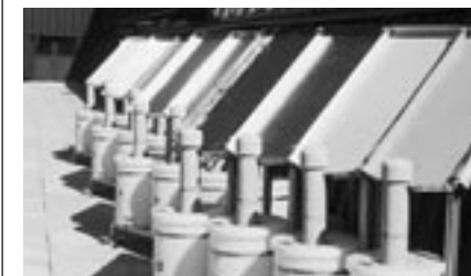
Am Freibewitterungsstandort der Empa in Dübendorf werden u.a. die Abtragsraten der Metalle gemessen.
