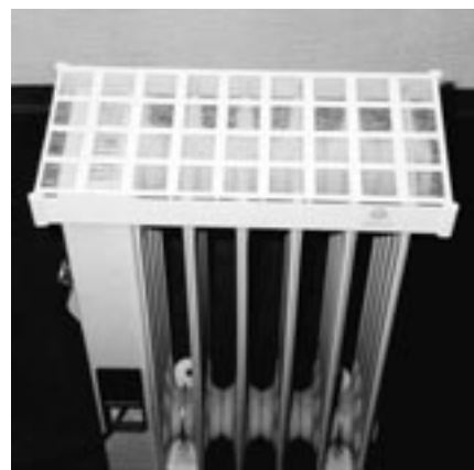
Staub-Filtrierung bei einem Elektro-Ofen.
