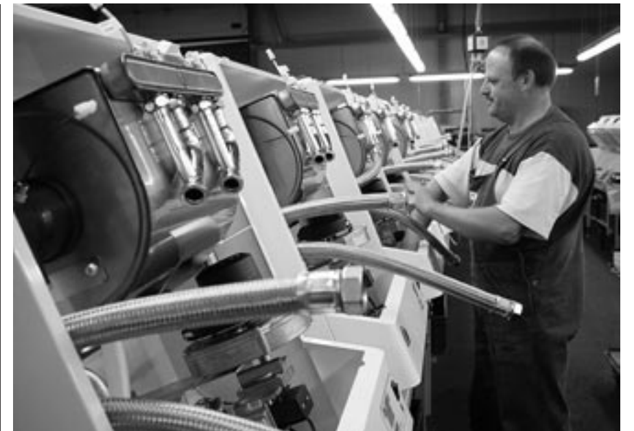
Produktion von Gas-Brennwertkesseln bei MAN Heiztechnik.
