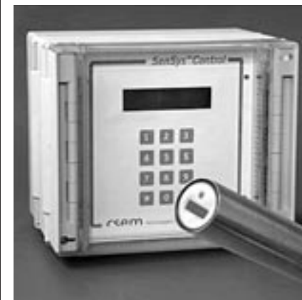
Die SenSys™-Control-Einheit für die Online-Überwachung der Wasserqualität.
