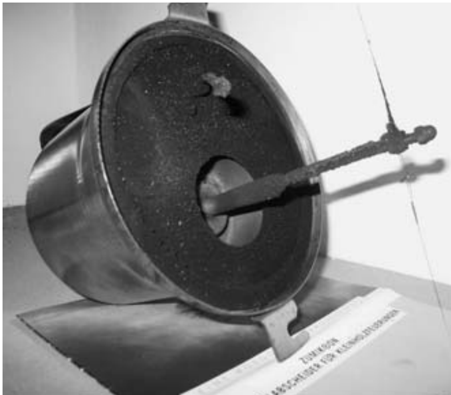
Der «ZUMIK@ON»-Elektrofilter, entwickelt von der Empa in Zusammenarbeit mit der Rüegg Cheminée AG in Zumikon ZH. Fotos: Holzenergie Kanton Bern, Trub BE
