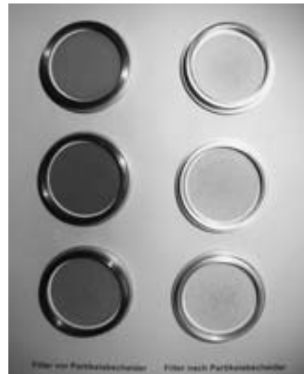
Der Mess-Filter vor und nach dem Einsatz eines Feinstaub-Partikelabscheiders.
