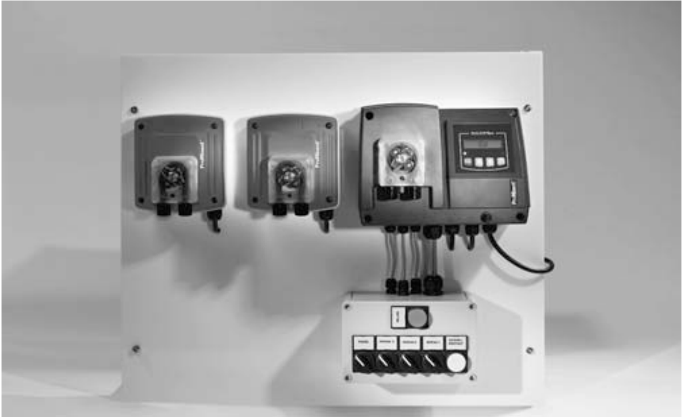
Schlauchpumpe Dulcoflex DF3a zur Duftstoffdosierung in Saunen, Dampfbädern und Whirlpools. In Kombination mit zwei Dulcoflex DF2a Dosierpumpen können drei verschiedene Duftstoffe zu unterschiedlichen Zeiten dosiert werden.
