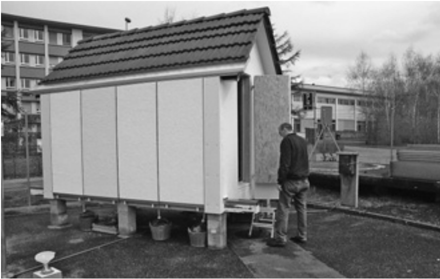
An diesem Modellhaus messen Forscher der Eawag und Empa wie der Regen Biozide auswäscht, welche zum Schutz vor Pilzen und Algen in Fassadenfarben und Putzen enthalten sind.
