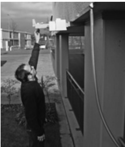
Mit solchen Rinnen haben die Forschenden an Neubauten in Volketswil ZH den Fassade-ablauf aufgefangen. Vor allem in den ersten Litern sind die Konzentrationen der Wirkstoffe sehr hoch.
