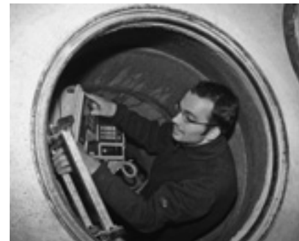
Probengabe im Regenwasserkanal einer neuen Überbauung in Volketswil ZH.
