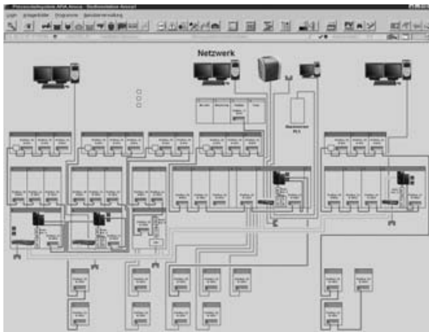
Gesamt-Schaltbild für die Anlagen-Steuerung mit Netzwerk-Rechner.
