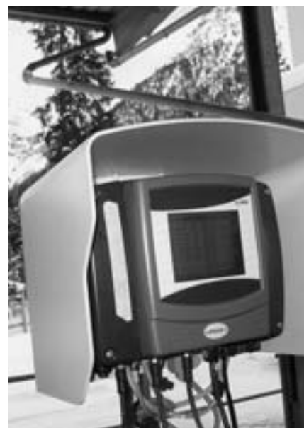
Aussen-Messgerät mit Schnittstelle zum «Profibus».
