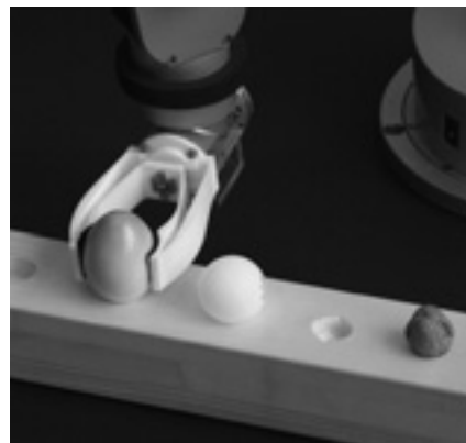
Aus intelligenten, nachgiebigen Material-Systemen lassen sich preiswerte Werkzeuge herstellen. Der Greifarm dieses Roboters zum Beispiel ist aus einem Guss gefertigt.
