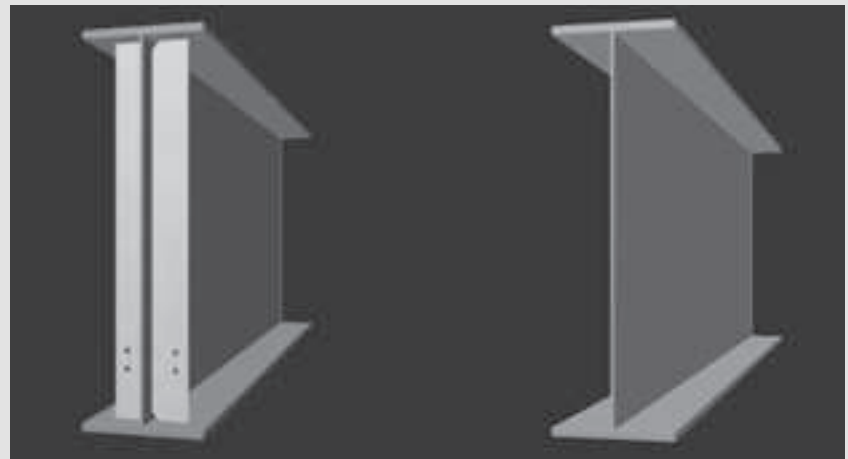
Skizze eines Trägers mit aussteifenden Endrippen (links) und ohne (rechts). Bild: Empa
