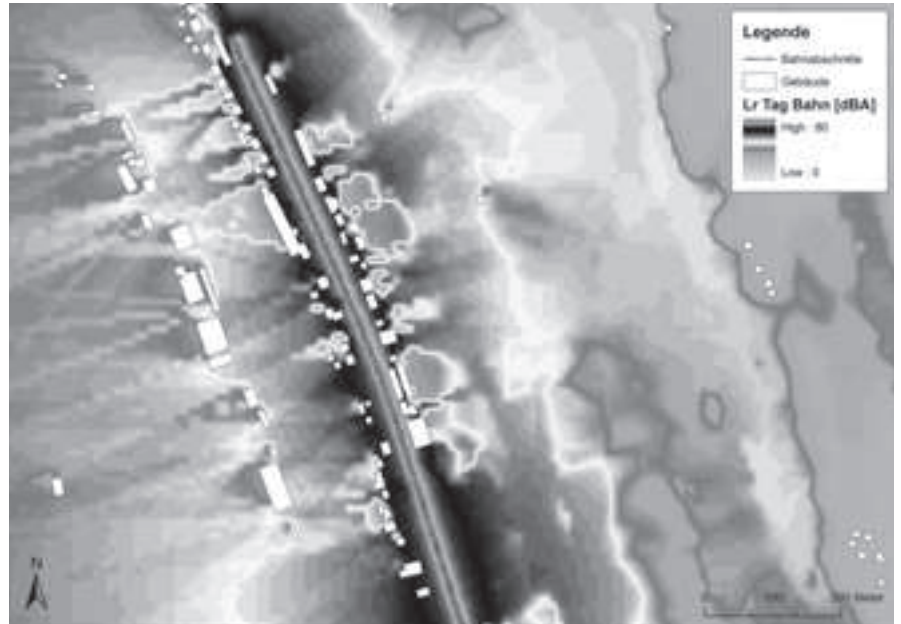
Die durch den Bahnverkehr entstehende Lärmbelastung entlang der Schienentrasse lässt sich mit Computerberechnungen genau vorhersagen (Quelle: LCC Consulting).
