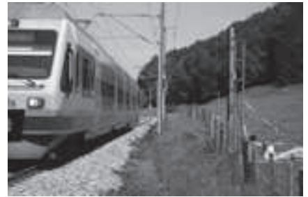
Lärmmessung an einer vorbeifahrenden Zugkomposition; im Vordergrund rechts die Messeinrichtung. Bild: Empa
