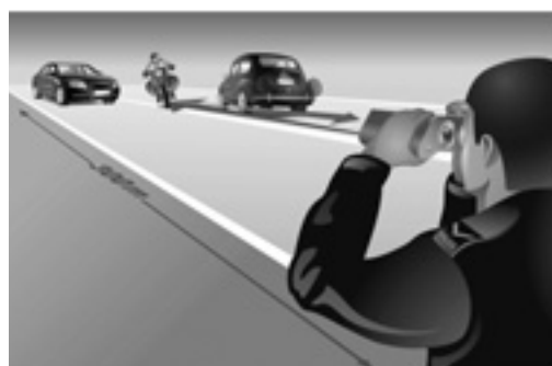
Bei punktuellen manuellen Geschwindigkeitsmessungen mit einem Lasergerät führt das Messpersonal die Messung ab Hand oder ab Stativ durch.
