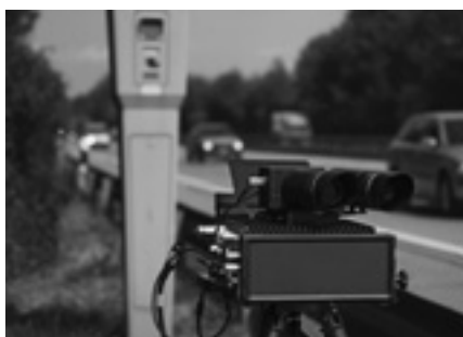
Radargeräte neuester Generation messen die Geschwindigkeit und die Entfernung zum Fahrzeug.
