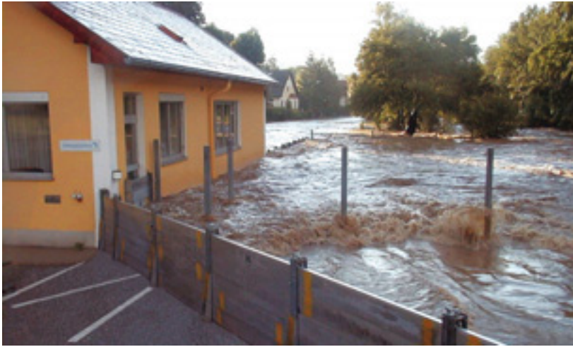
TALIMEX-Hochwasser-Schutzwand Typ HSW 100 cm hoch, 5-fach gestapelt, geschraubt.
