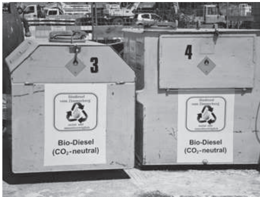
Biodiesel-Tank auf der Baustelle.
